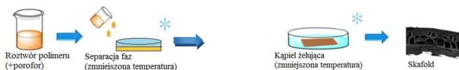
Rysunek 7. Otrzymywanie substytutów kości gąbczastej metodą „freeze extraction”.
